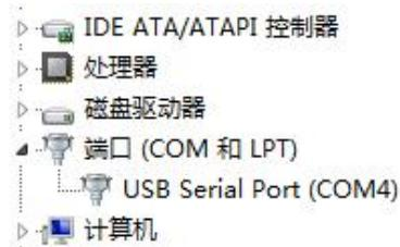
(1) 确认后, 给驱动器通电, 打开调机软件, 文件下拉, 串口设置, 选择对应的串口号。然后打开串口。
