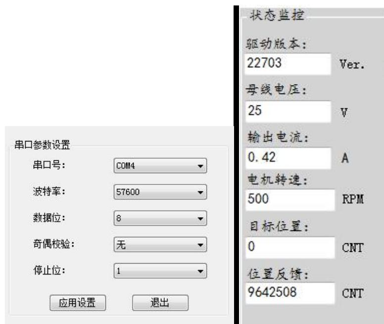
(4) 打开串口后, 第一次软件会自动把驱动内部设置参数读入。若通讯失败, 左下角会显示通讯故障, 或读入参数失败。判断通讯是否成功, 以是否读入到驱动版本为条件。若驱动版本为 UNKNOWN, 通讯失败, 请检查硬件连接。
